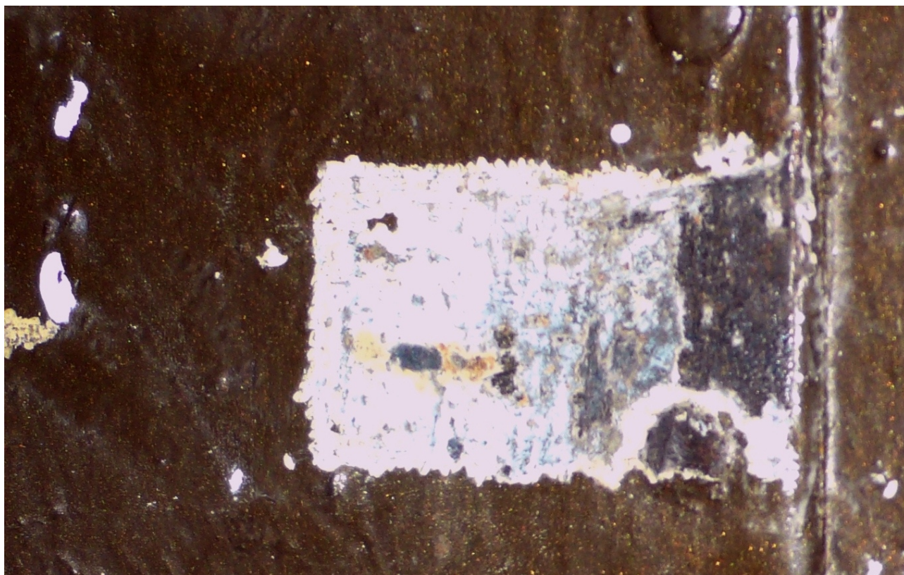
železné dveře: na kovu stopy zeleného nátěru – následuje bílá šedá, další zelená a okrová
